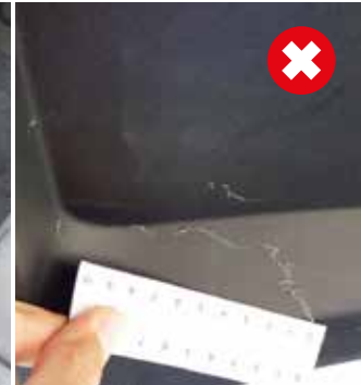
Rayure sensible à l'angle ou arrachement de matière. Garniture cassée, percée, réparation de mauvaise qualité.
